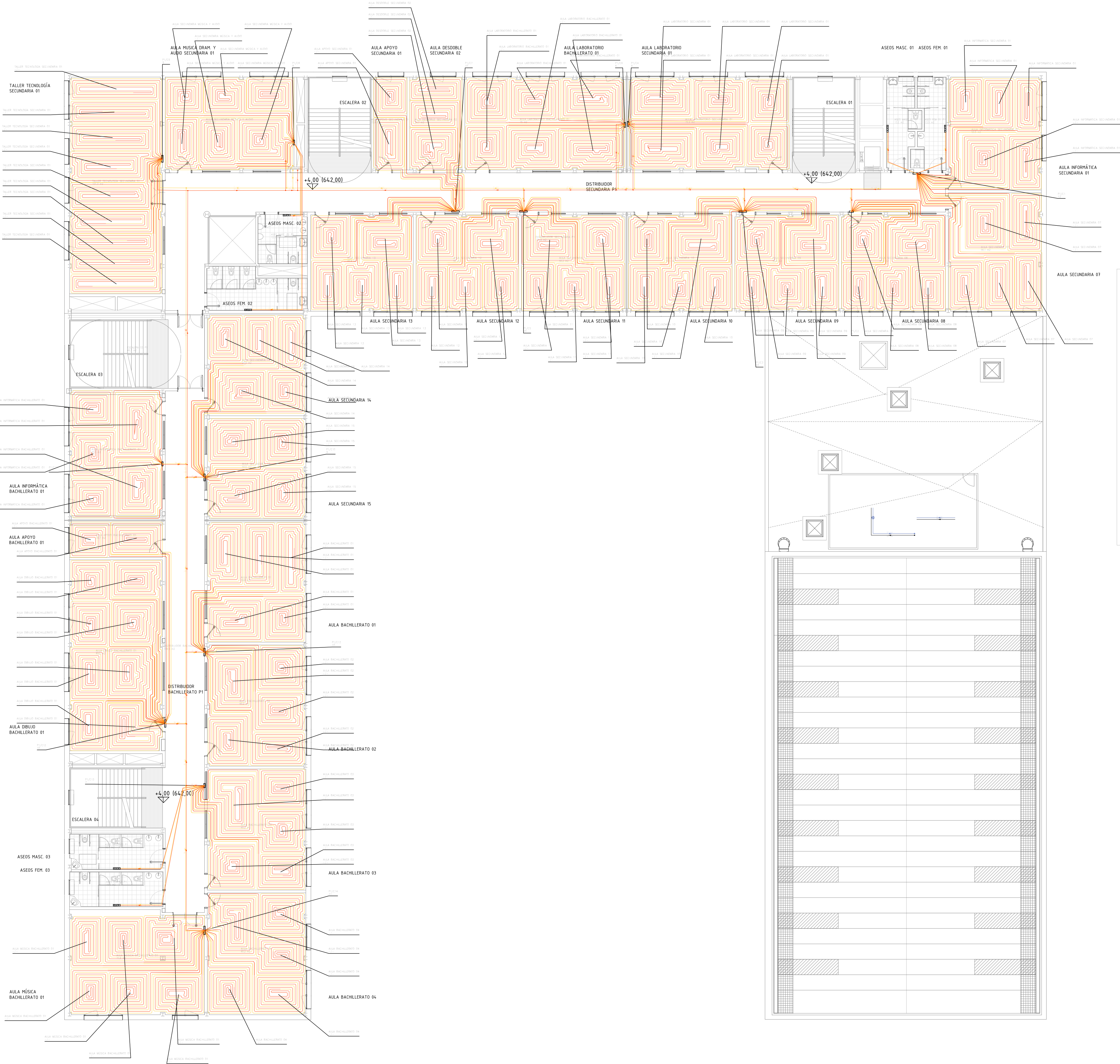
PLANTA PRIMERA SUELO RADIANTE - AEROTERMIA ESCALA 1:150
